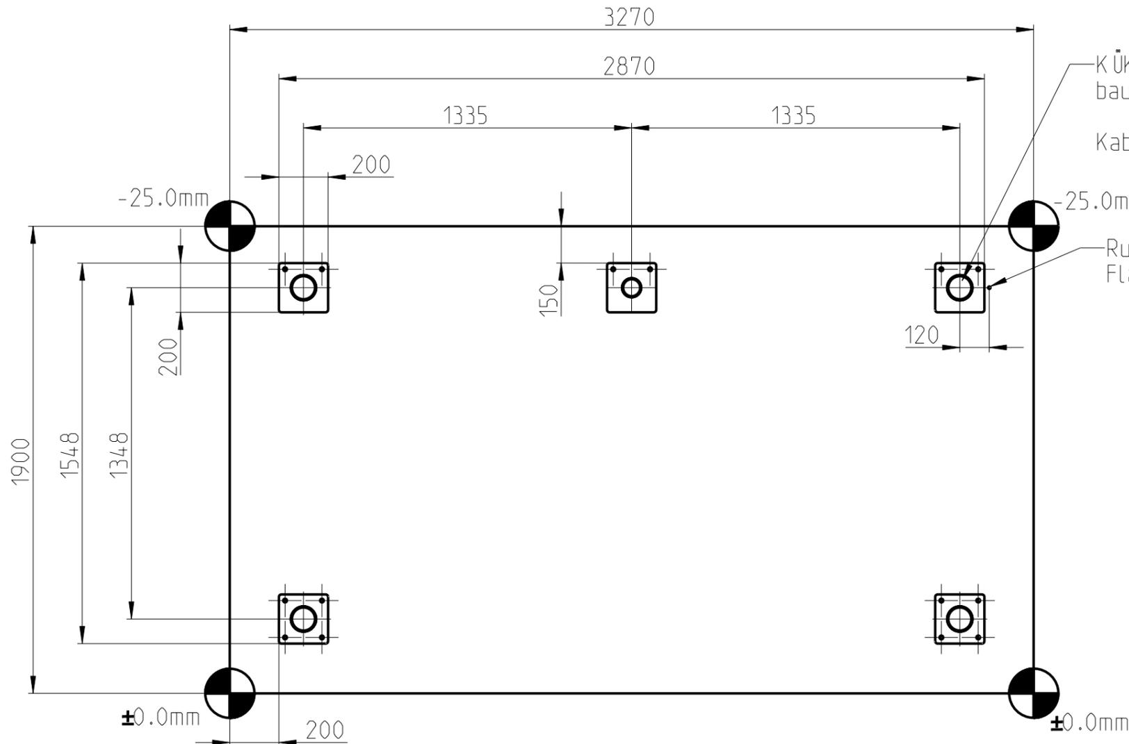
KÜK Verkabelung 230V - Kabellänge ca. 2m aus Boden bauseits
